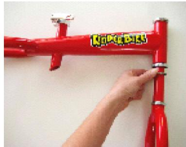
6. nasadte vrchní věneček ložiska na vidlici kuličkami směrem dolů
